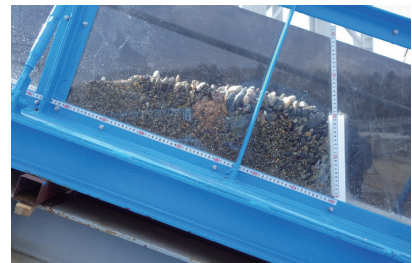
捕捉状況(水理模型実験側面)
