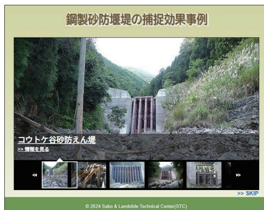
図-3 鋼製砂防構造物の効果発揮事例
