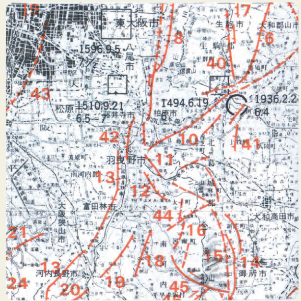
図-4 大和川断層帯(図の数字10) 活断層研究会「新編 日本の活断層」(東京大学出版会、1991年) (75%に縮小)
