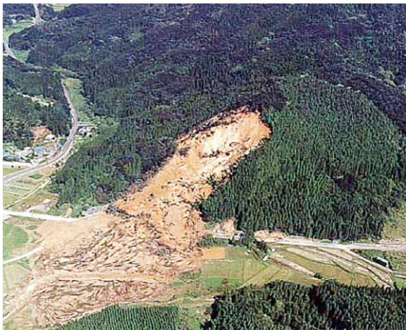
写真-1 毘沙門地すべりにおける堆積末端の流動化状況 (http://www.nan9.co.jp/)
