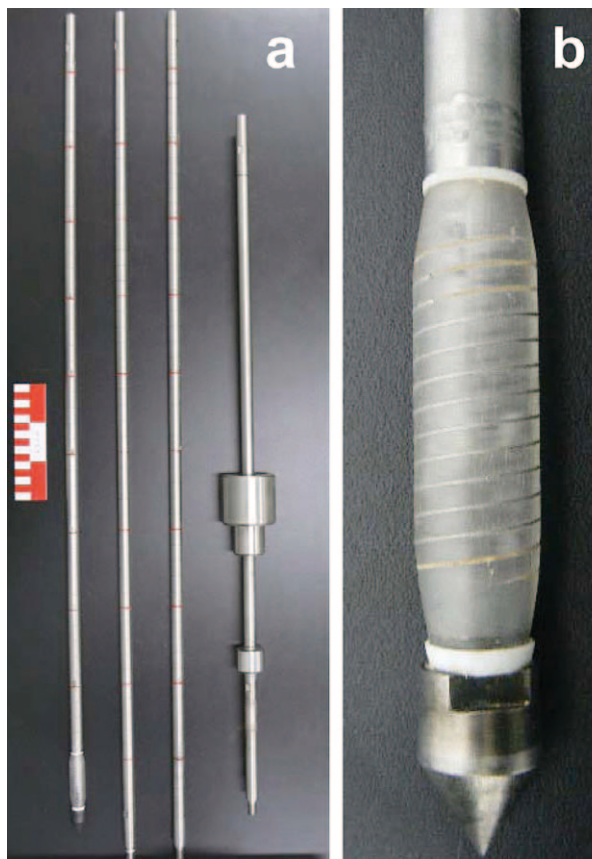
写真-2 水分計付貫入計 (CPMP) の全体 (a) と先端部 (b)
