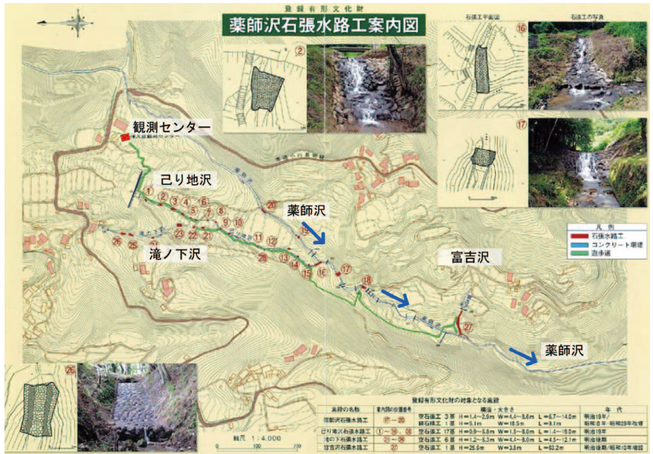
図-2 薬師沢石張水路工案内図（長野県土尻川砂防事務所資料に加筆）
