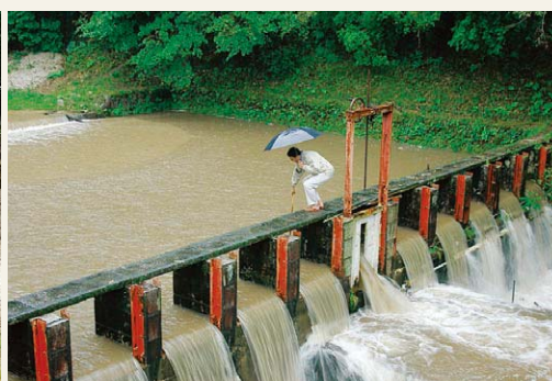
写真-11 ウォッシュロードのサンプリング 流量と濃度の校正曲線を作成し、年間の流量からウォッシュロードを算出する
