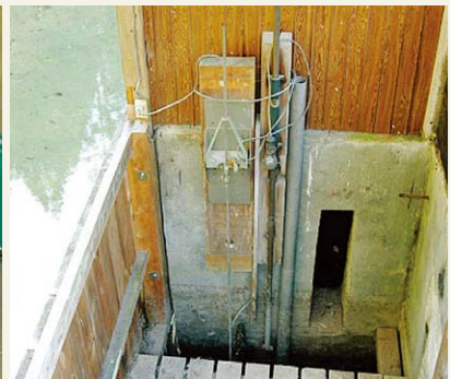
写真-3 ポイントゲージ すべての記録のベースとなる。週に一度の手観測の記録
