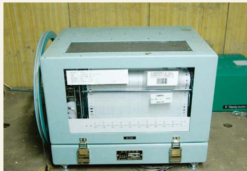
写真-2 ロール紙とペンによる水位記録装置 (バックアップ用)
