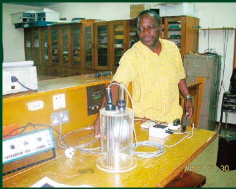
写真-6 警報装置付き簡易雨量計の製作 (トリニダードトバゴ)
