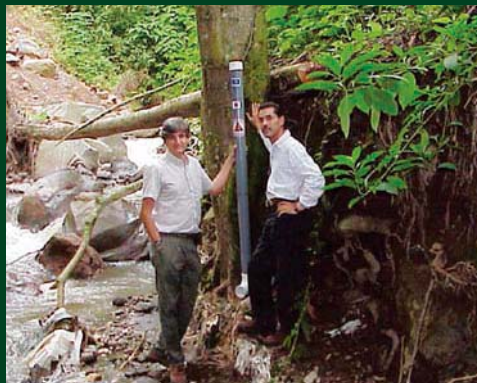
写真-7 警報装置付き簡易水位計の設置
