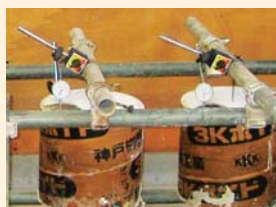
写真-1 各種アンカー体 耐久性試験観測状況
