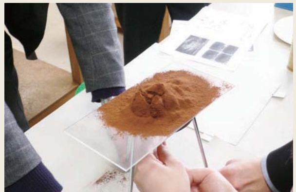
写真-3 ココアの山の中にチョコレートを注入。割れ目が入っています
