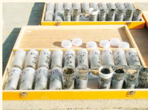
アンカー長を決定するためのスライム採取状況
