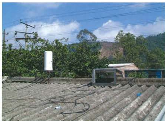
写真-4 警察庁舎屋根の雨量計とソーラーパネル。写真中央がラス・コリナスの崩壊。
