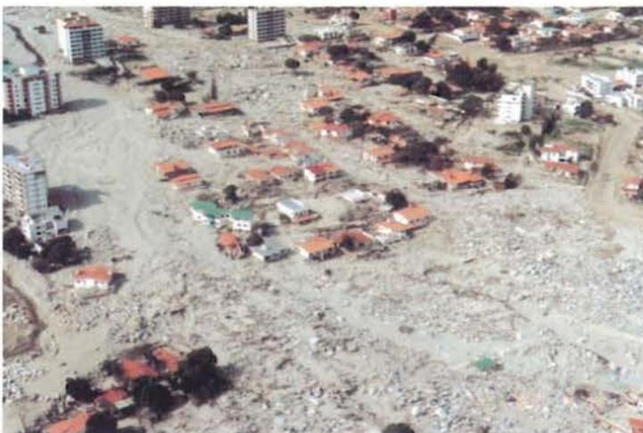
写真-2 サン・フリアン渓流の土石流堆積による建物の被害状況
