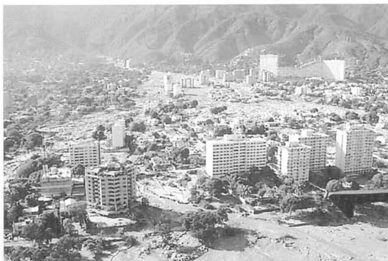
下流域より見たロスコラレス地区の土石流の氾濫・堆積状況
