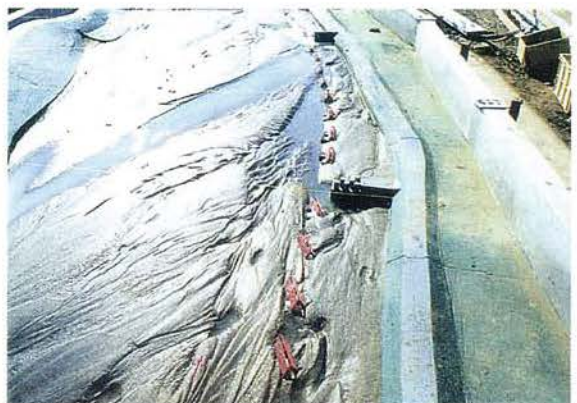
(b) 実験終了直後における水制工周辺の河床状況
