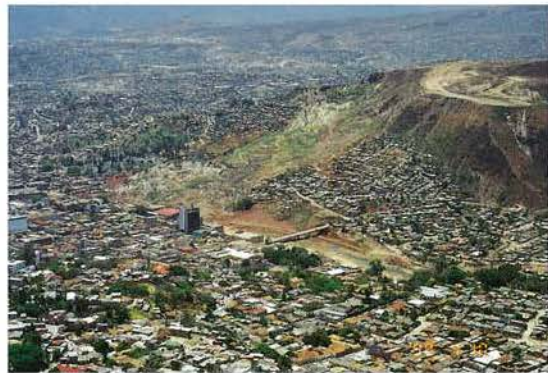
写真-1 地すべり地遠望 (ピカッチョ山公園から) 家屋群の途切れる斜面が地すべり。 Choltecalca川にかかるチレ橋も損壊が著しい。
