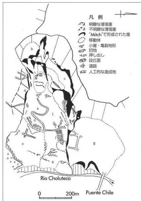
図-6 ソト地区空中写真判読図（災害後）
