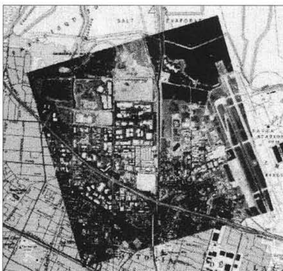
図-18 リモートセンシングとGISの統合例 —高解像度画像はそのまま地図として使用できる— (出典：IKONOS：Space Imaging Co., Ltd.)
