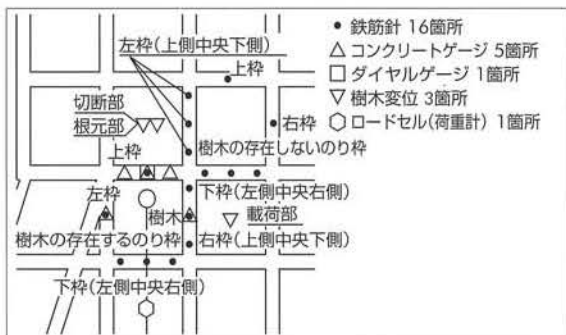
図-3 計測機器配置図(平面図)
