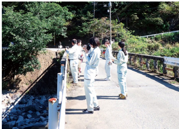
春木川橋にて保全対象の確認および橋梁の桁下クリアランスの計測
