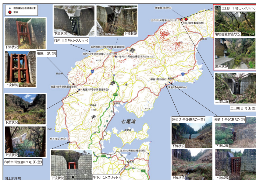
図-3 鋼製透過型砂防堰堤 位置図及び現地状況写真 ※ ※ 図は地理院タイルに震源、堰堤位置・名称等を追記して作成。(写真提供:日鉄建材(株)、JFE 建材(株)、(株)共生)
