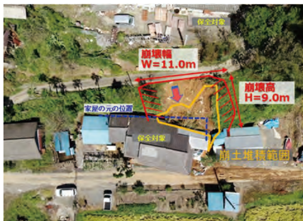
写真-3.9 宮崎県日向市東郷町下三ヶの被災状況 (写真提供：宮崎県)
