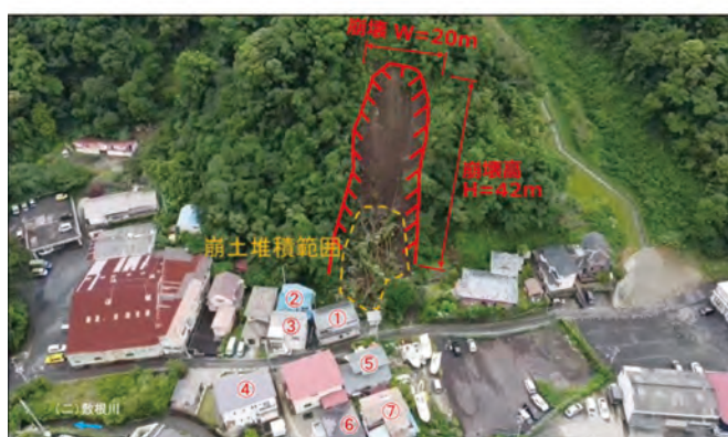
写真-3.7 静岡県下田市敷根の被災状況 (写真提供：静岡県)
