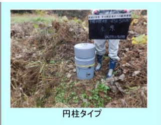
積雪寒冷地における観測機器保護施設の例
