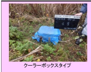
積雪寒冷地における観測機器保護施設の例
