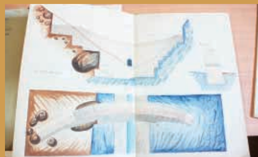
写真-8 1800年代後半の砂防えん堤の設計図
