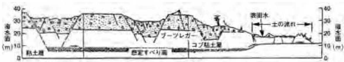
図1 アンカレッジ、ガバンメント・ヒル地すべりの地質断面図 3)
