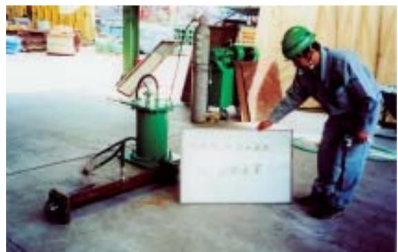
写真2-1 アンカー頭部背面の防水性能試験状況
