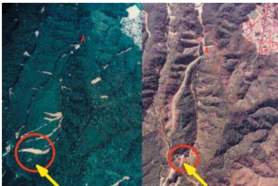
写真-1 同一斜面で崩壊が発生している事例
