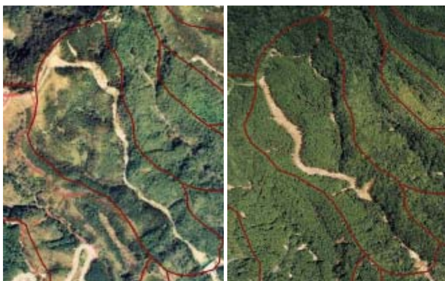
写真-2 異なる斜面で崩壊が発生しているが、同一流域内で崩壊が発生している事例（右：昭和48年災害時、左：平成15年災害時、太宰府市原川）
