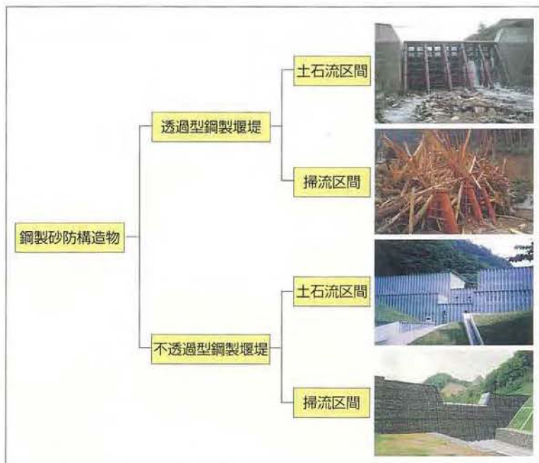
図1 鋼製砂防堰堤の分類
