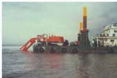
写真3-4 水中掘削に威力を持つバックホウ船
