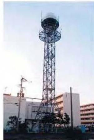
写真3-7 小型レーザー雨量計
