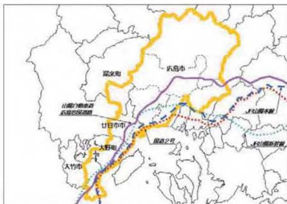
図7 広島西部山系直轄砂防事業区域 3市2町に跨る621km 2 の区域内に約1,700の危険渓流
