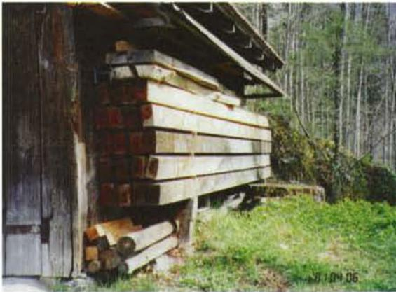
写真4 保管された堰板
